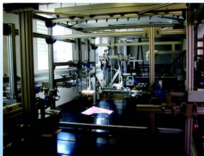
Instalación de estructura para ensayar muebles
